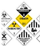
Le symbole du danger prépondérant de la matière, doit être apposé **sur l'emballage et sur le véhicule**
